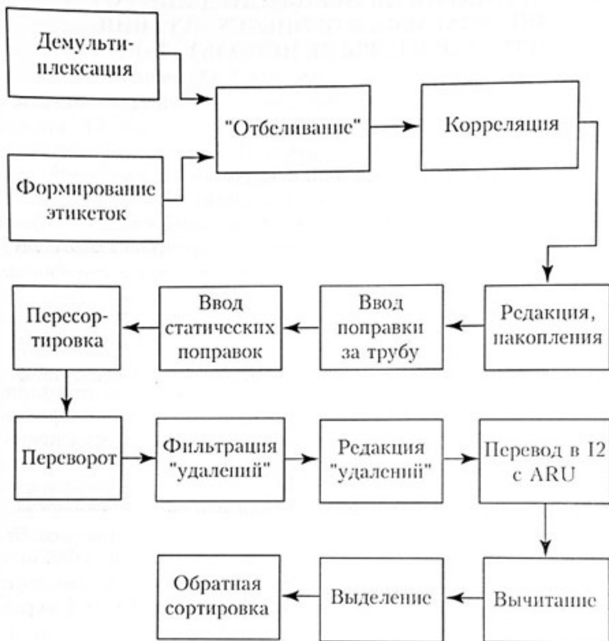
Рис. 1. Принципиальная схема обработки материалов ВСППБ в комплексе SDP.
