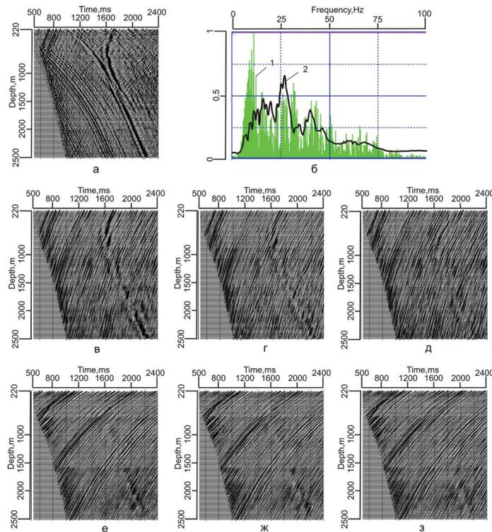
**Рисунок 2.** Пример применения частотного редактирования спектра для подавления низкочастотных регулярных помех при селекции волн. а) исходное волновое поле (R-компонента), б) наложение спектра одной редактируемой трассы (1) и среднего спектра (2), в)-д) результаты селекции отраженной Р волны без частотного редактирования спектра, с частотным редактированием спектра после первой и второй итерации соответственно, е)-з) те же результаты селекции отраженной S волны.
