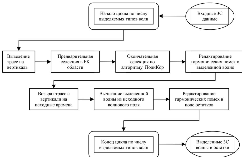
**Рисунок 1.** Структурная схема селекции данных одного ПВ с применением редактирования гармонических помех.
