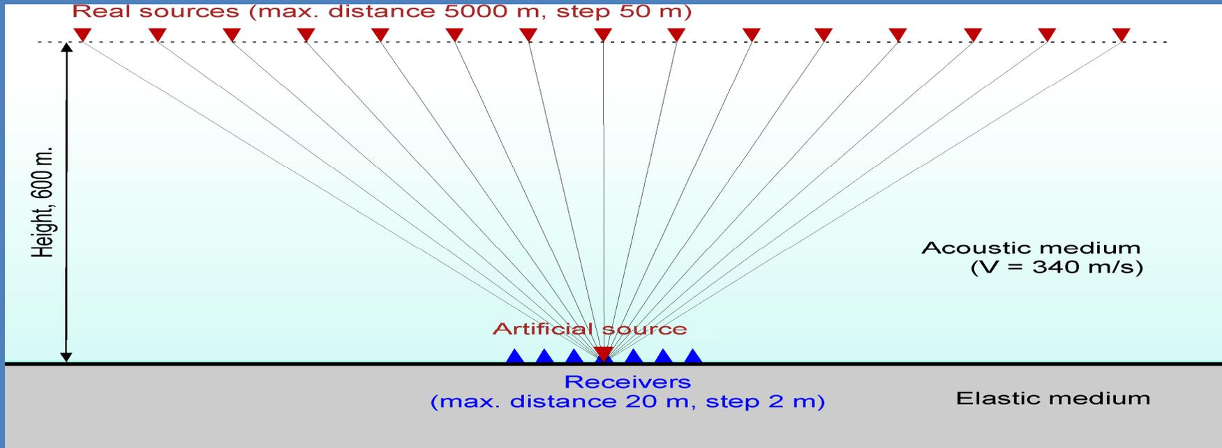
Рис.2. Геометрия модельного эксперимента. / Fig.2. Modeling geometry
