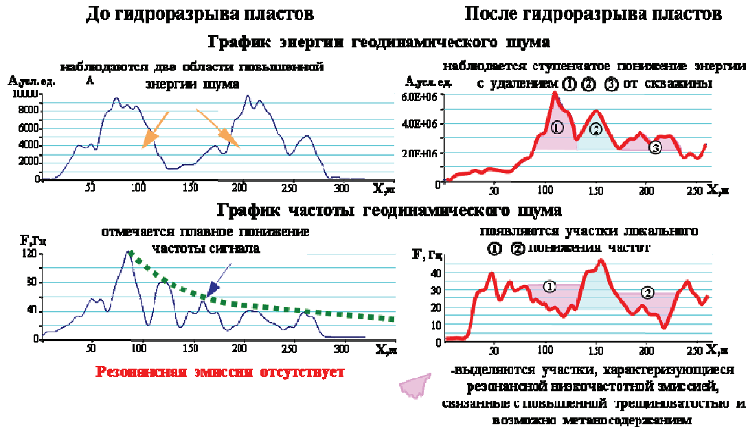
Рисунок 3. Низкочастотная резонансная эмиссия в волновом поле геодинамического шума ВСП, обусловленная изменениями внутренней трещиноватости после применения гидроразрыва
