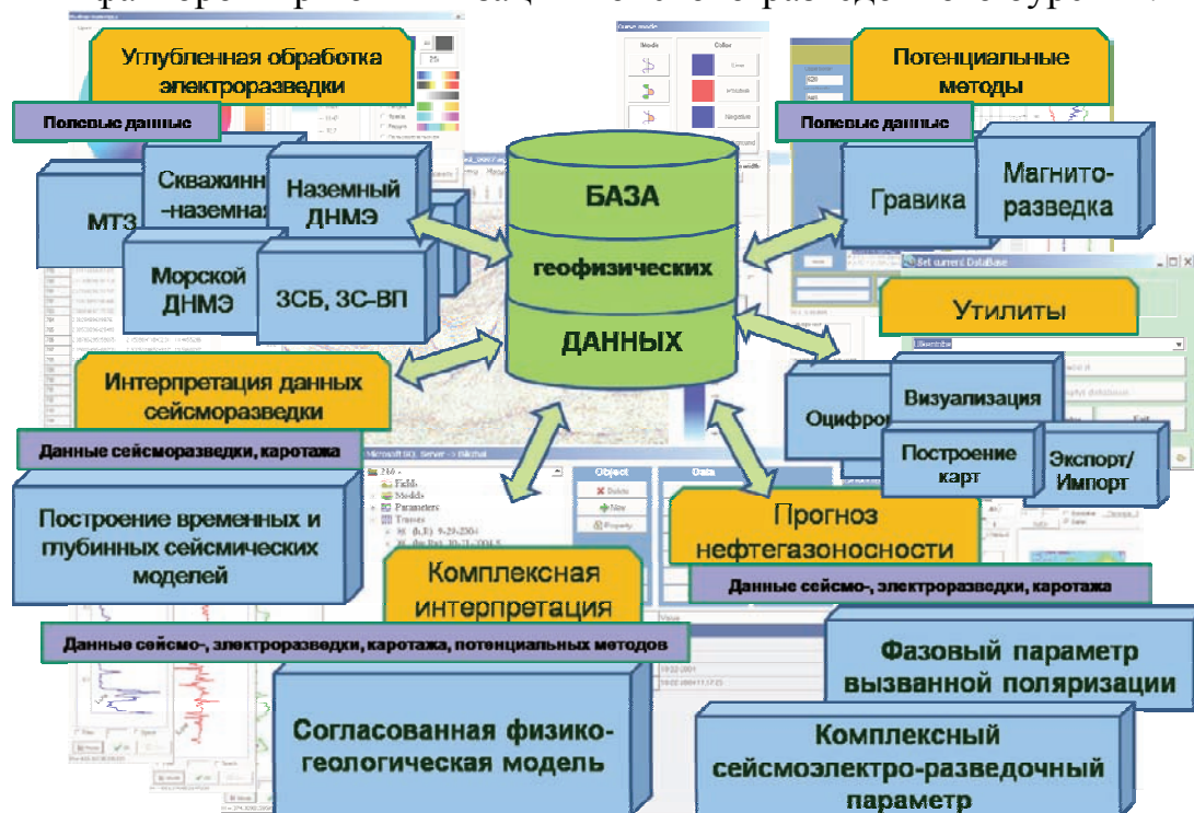
Рис. 1. Блок-схема программного комплекса технологии GeoVisor
