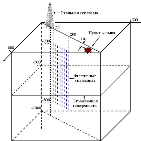
Рис. 1. Схема модельного эксперимента.
