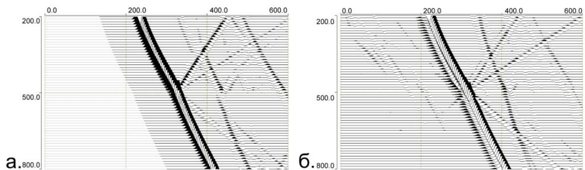
Рис. 2. а. Исходное синтетическое сейсмическое поле для изотропной двухслойной среды. Скорости продольных и поперечных волн в верхнем пласте 2000 м/с и 1000 м/с, в нижнем 2500 м/с и 1250 м/с.
