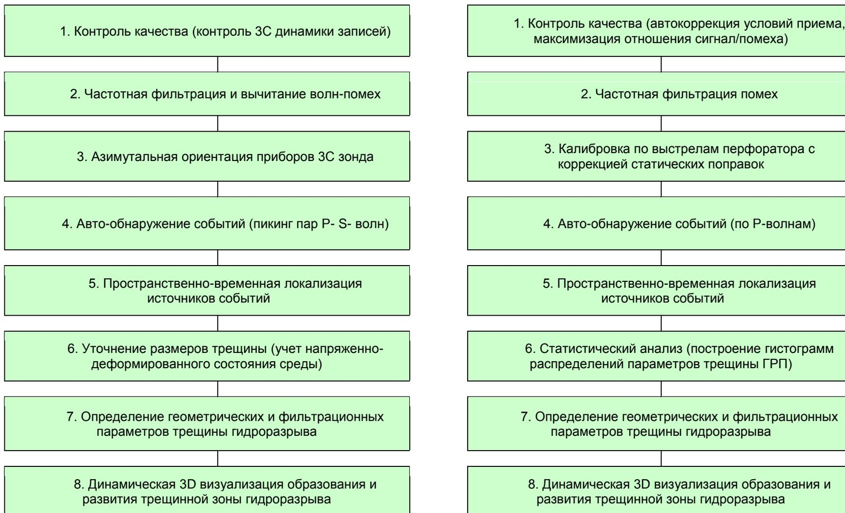
Рис. 4. Блок-схемы обработки данных скважинного (слева) и наземного (справа) микросейсмического мониторинга ГРП
