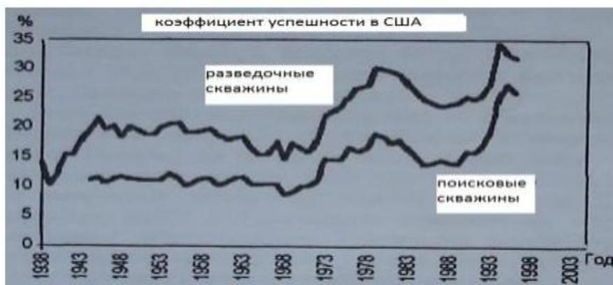
Рис. 1. Динамика изменения коэффициента успешности при бурении поисковых и разведочных скважин в США [2].
