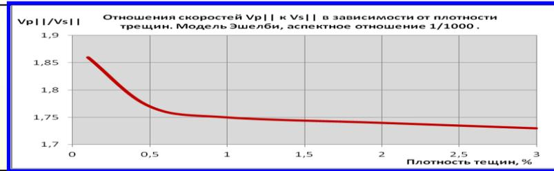
Наличие трещиноватости приводит к уменьшению абсолютных значений вертикальных продольных скоростей и их отношений к вертикально-поляризованным поперечным скоростям
