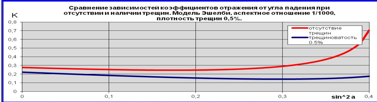
Наличие трещиноватости приводит к изменению абсолютных значений коэффициентов отражения продольных и обменных волн в зависимости от угла падения.
