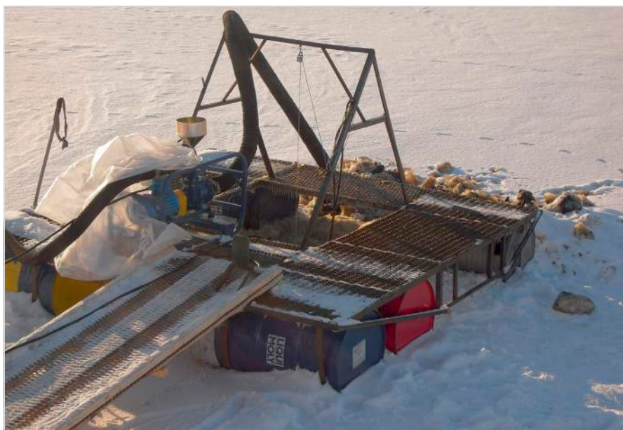
Самодельное понтонное устройство с установленной на ней грязевой помпой. Вода для размыва подается на зафиксированный ствол брандспойта
