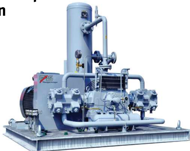
Рис. 1 — Горизонтальный компрессор HG601BB для работы с СУГ Производительность — до 390 м³/час; Привод — электромотор 58 кВт, EExellT3; Минимальное входное давление — 0,8 бар; Дифференциальное давление рабочее — 10 бар; Подключение — DN80 (вход/выход).
