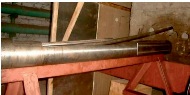
Рис. 9 — Процесс бурения канала в песчаном блоке КНБК перфобура с гибким соединением
