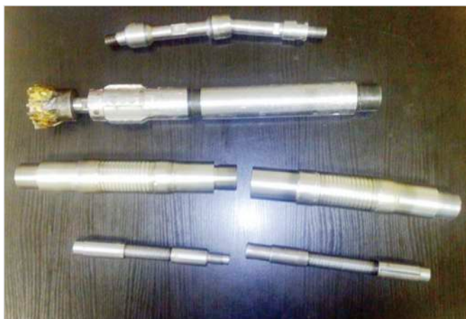
Рис. 6 — Шпиндельная секция с шарнирным соединением (сверху) и гибкие межкорпусные и межторторные сочленения перфобура (внизу)
