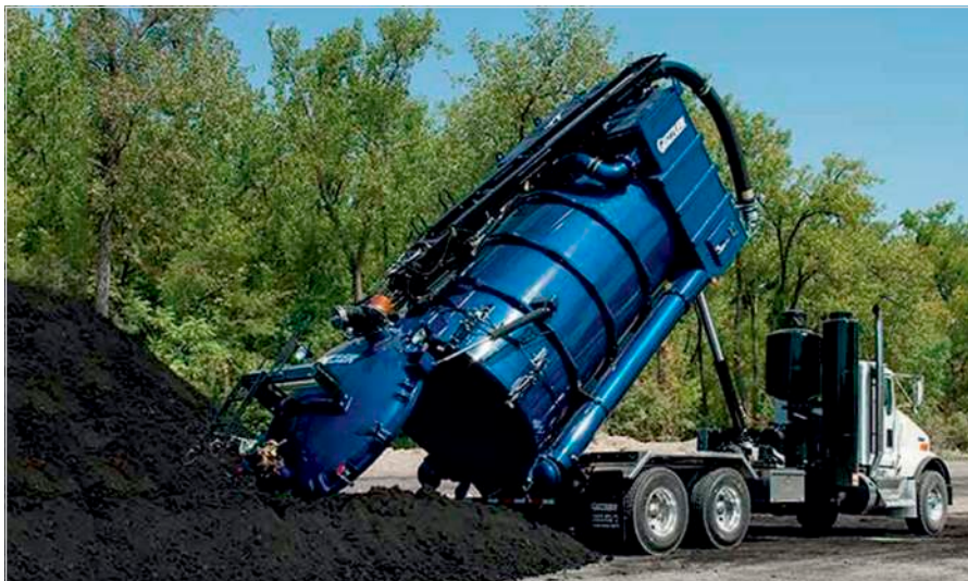
Guzzcavator от американской компании Guzzler — благодаря удобной выгрузке может забрать даже нефтезагрязненный грунт
