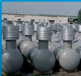
Резервуары для сжиженного газа
